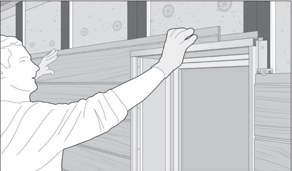
Продолжайте монтаж. Для монтажа доски над окном расчертите контур верха окна на задней стороне доски и обрежьте ее с помощью электролобзика (распиловка осуществляется с задней стороны доски). Убедитесь в том, что доска установлена над окном на одном уровне с другими досками в ряду, затем закрепите ее с помощью клеймера и самореза.
